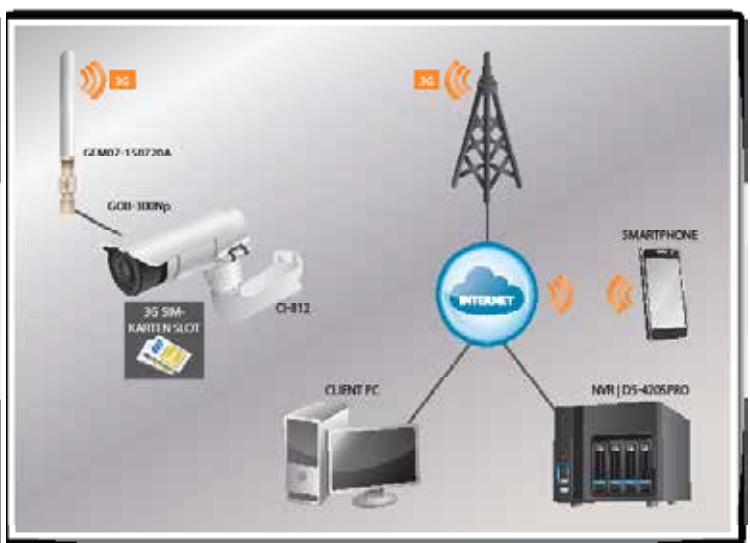
Mobilfunk-Kamera mit SIM-Kartenslot Unabhängigkeit gegenüber lokalem Internet z.B. für Baustellen- oder Verkehrsüberwachung
